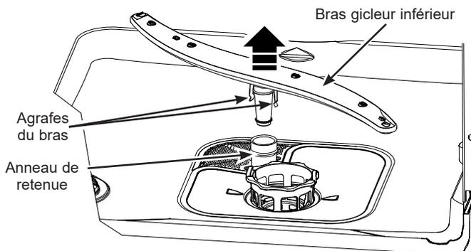
**IMPORTANT** : Lors de la remise en place, assurez-vous de tourner l'écrou de retenue fermement pour le verrouiller sur le tube d'alimentation d'eau. Assurez-vous que le bras gicleur est solidement fixé et qu'il pivote librement.
