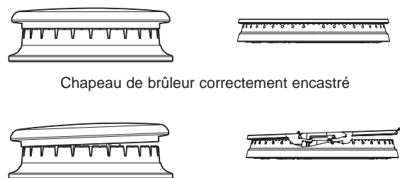
Chapeau de brûleur incorrectement installé
