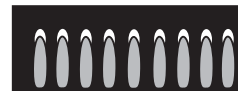
(B) Extrémités jaunes sur les cônes extérieurs — Normal pour le propane (LP)
