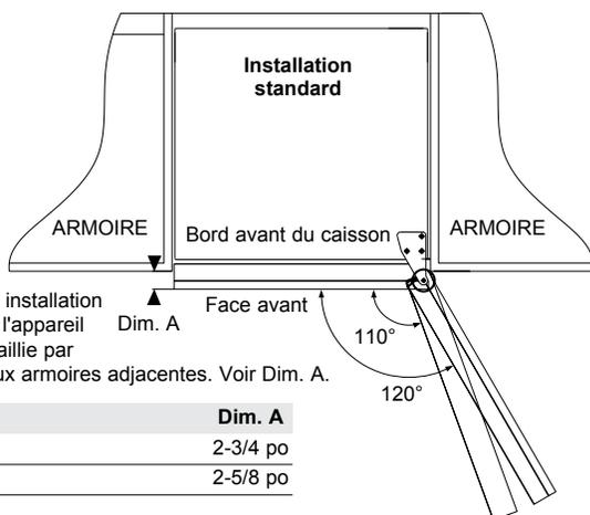
Dans une installation standard, l'appareil sera en saillie par rapport aux armoires adjacentes. Voir Dim. A.
