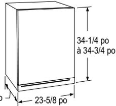
L'appareil doit être installé de manière à ce que la façade du panneau personnalisé fasse saillie de 2-3/4 po à l'avant des armoires adjacentes. Cette position permettra une ouverture complète de la porte et empêchera les interférences avec les armoires adjacentes. L'ouverture entre les armoires doit être d'au moins 23-3/4 po. Ces modèles ne peuvent pas être installés encastrés dans des armoires de 24 po de profondeur.
