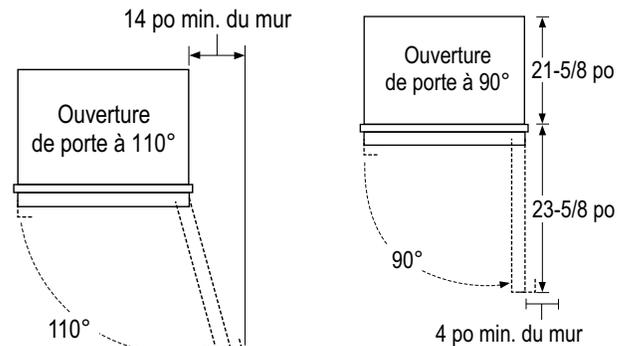
**REMARQUE :** Les dégagements sont basés sur la profondeur d'installation de la poignée recommandée de 2-1/4 po.
