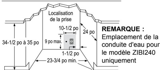
**REMARQUE :** Si vous installez l'appareil entre des armoires sans cadre, une bande de finition ou un panneau latéral de 1/2 po de large peut s'avérer nécessaire du côté des charnières. La bande de finition agira comme une entretoise entre le cadre de la porte et l'armoire adjacente et empêchera toute interférence avec l'ouverture de la porte de l'armoire. La largeur de la découpe doit inclure les panneaux de finition.
