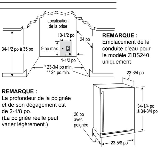
\* **Installation standard :** L'appareil doit être installé de manière à ce que la face avant en acier inoxydable fasse saillie de 1-5/8 po à l'avant des armoires adjacentes. Cette position permettra une ouverture complète de la porte et empêchera les interférences avec les armoires adjacentes. L'ouverture entre les armoires doit être d'au moins 23-3/4 po.
